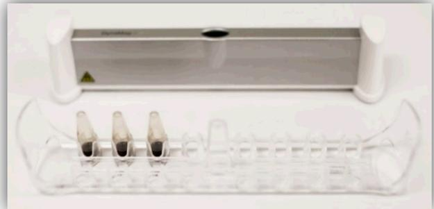
b. Die Dynamag-Magnetbasis umdrehen und auf das leere Rack stecken.
