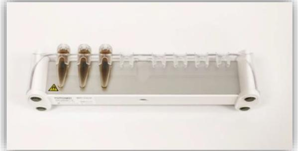
d. Inclinez lentement l'appareil de 90° vers vous tout en le maintenant en contact avec la surface de travail, de façon à le remettre à la verticale, les tubes face à vous.
