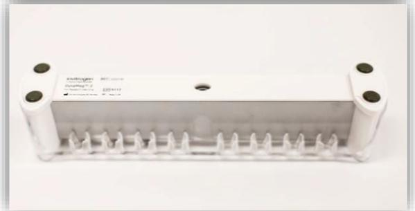
c. Inclinez lentement l'appareil de 90° vers vous tout en le laissant en contact avec la surface de travail. Les tubes sont maintenant horizontaux et visibles.
